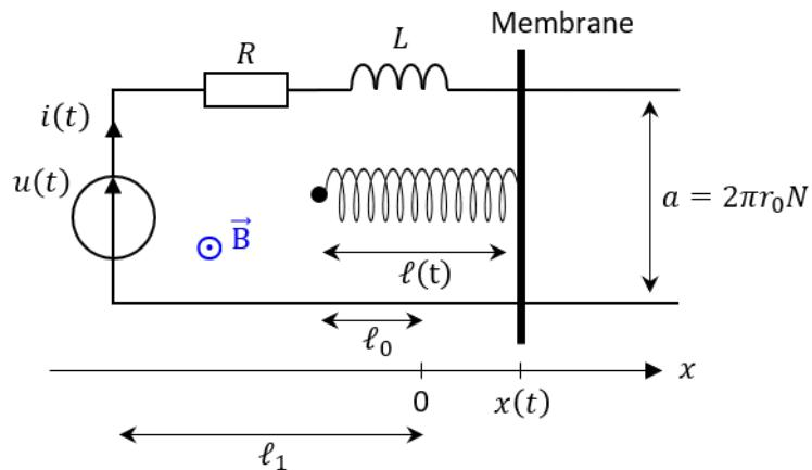
Le haut parleur est alimentée par un générateur  $u(t)$ . On note  $R$  la résistance totale des fils,  $L$  l'inductance propre de la bobine.
