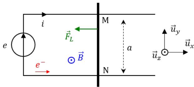
Lorsqu'on allume le générateur : la tige se met en mouvement. On en déduit qu'une force est apparue, appelée **force de Laplace**. Si on inverse le sens du générateur ou du champ magnétique, la tige part dans l'autre sens.
